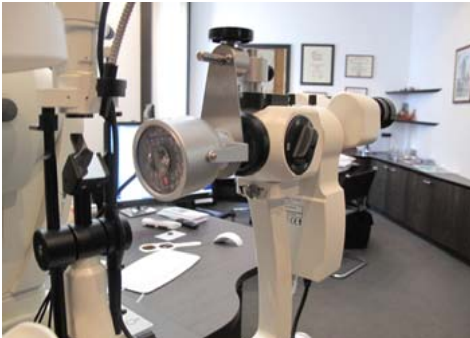
Bild 3: Infrarot CCD Kamera mit optischem Nahausgleich; zur besseren Handhabung auf einer SLM montiert.
